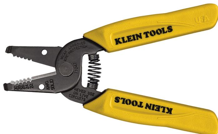
Das Abisolier- und Schneidwerkzeug von Klein Tools ist ein kompaktes und leichtes Werkzeug für das Abisolieren und Schneiden. Besteht aus gehärtetem Stahl und schneidet, entmantelt, windet und biegt massiven Draht. Die schmale Spitze reicht auch in beengte Bereiche.
