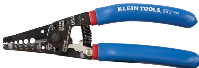
Diese(r) Abisolierzange/Schneider von Klein-Kurve schneidet, entmantelt und windet Kupferlitzen verschiedener Größe. Präzisionsklingen sorgen für einen sauberen Schnitt. Löcher zum Kürzen von Schrauben schneiden sauber Schrauben von 6-32 und 8-32.
