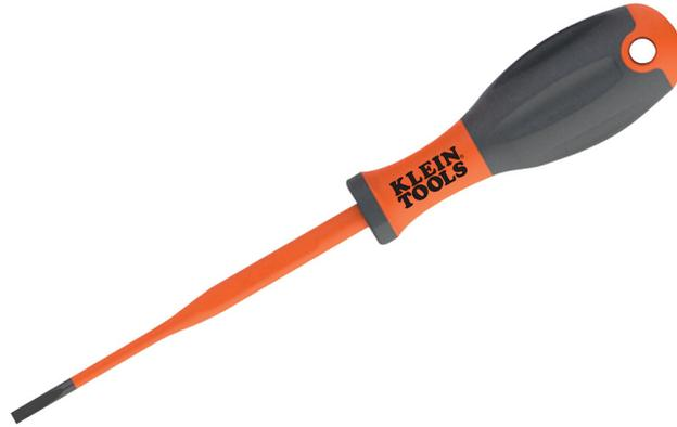
Die gemäß dem VDE isolierten Schraubendreher verfügen über einen ergonomischen Griff für ein höheres Drehmoment und mehr Komfort. Sie erfüllen oder übertreffen die Standards IEC 60900 und ASTM F1505 für isolierte Werkzeuge und sind deutlich mit dem offiziellen 1000-Volt-Zulassungssymbol gekennzeichnet. Anti-Roll-Design erschwert Werkzeugverlust, und die schmalere Spitze vereinfacht den Zugriff auf Leistungsschalter und andere kleine Objekte.
