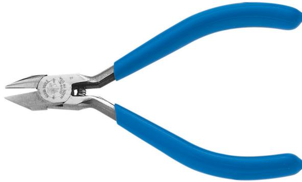
Schmale Backen und schmales Scharnier für Präzisionsarbeiten in beengten Bereichen. Scharfe Spitze für präzises Schneiden dicht an der Spitze. Selbstöffnung durch Federkraft. Kurze Backen und abgeschrägte Schneidkanten erlauben kurze Schnitte. Induktionsgehärtete Messerklingen sorgen für Langlebigkeit. Warm genietetes Scharnier sorgt für reibungslose Arbeit ohne Wackeln der Griffe. Kunststoff-getauchte Griffe zur bequemen Handhabung und leichten Erkennung. Werkzeug-Spezialstahl, Made in USA.
