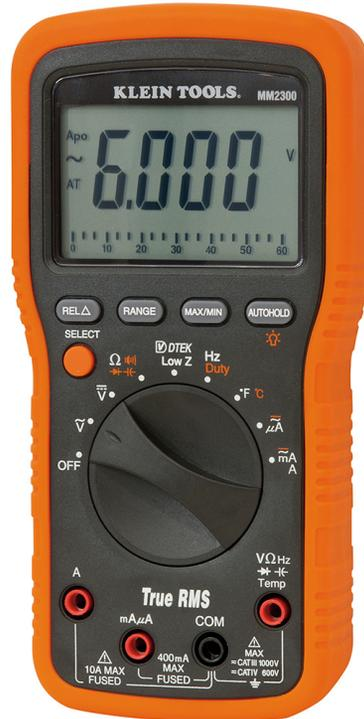
Das Klein Tools MM2300A ist ein True-RMS-Multimeter mit automatischer Messbereichswahl. Es misst die AC/DC-Spannung, niedrige Impedanzspannung, AC/DC-Strom, den Widerstand, die Kapazität, die Frequenz, das Tastverhältnis und die Temperatur. Es kann außerdem Dioden- und Durchgangsprüfungen vornehmen. Mit Gehäuse, Thermoelement, Messleitungen und Batterien von Klein
