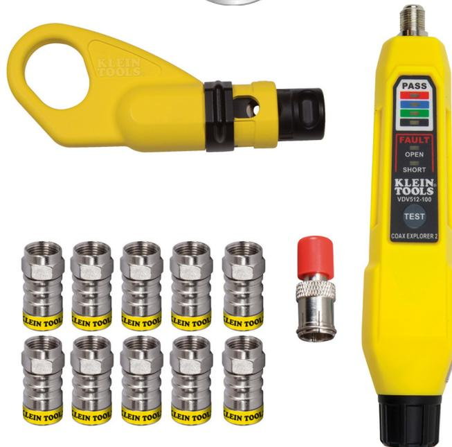
Enthält die Werkzeuge zum Vorbereiten, Anschließen und Prüfen von Koaxialkabeln. Radial-Abisolierwerkzeug für die einfache Vorbereitung von Koaxialkabeln in einem Arbeitsschritt. Kompaktes Crimpwerkzeug zum schnellen und zuverlässigen Crimpen von F-Kompressions-F-Steckverbindern. Kompakter Coax Explorer2 testet Verbindungen (gut/Unterbrechung/Kurzschluss). Push-On-Steckverbinder (RG6/6QS) für werkzeuglosen, patentierten Greiffmechanismus für einfache Montage und starken Halt.
