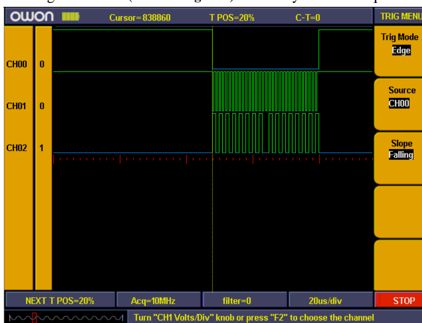
Fig.5-55: Edge trigger setting
