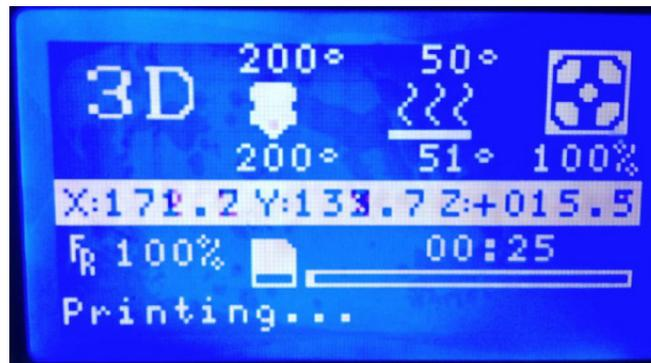
(En haut figure la température prédéfinie et sur le bouton, la température réelle)
