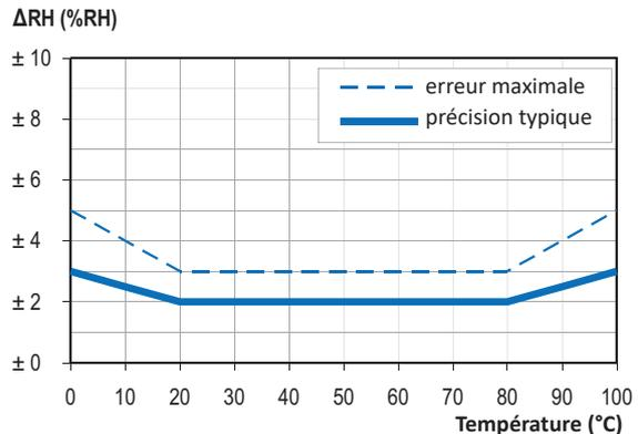
Précision typique des mesures d'humidité relative données en % HR pour des températures de 0 à 80°C.
