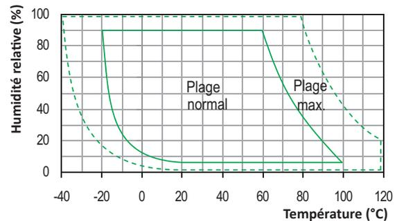
Une exposition à long terme à des niveaux d'humidité en dehors de la plage "normale" peut temporairement contrebalancer les mesures d'humidité relative ( $\pm 3$  % HR après 60 heures). Une fois que les conditions se seront stabilisées, l'appareil reviendra lentement à l'état d'étalonnage.
