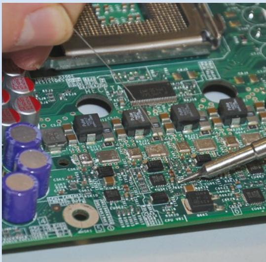
Die Lötspitze ist das Herzstück des LötKolbens und verantwortlich für den Wärmefluss vom Heizelement über das Lot zur Lötstelle.
