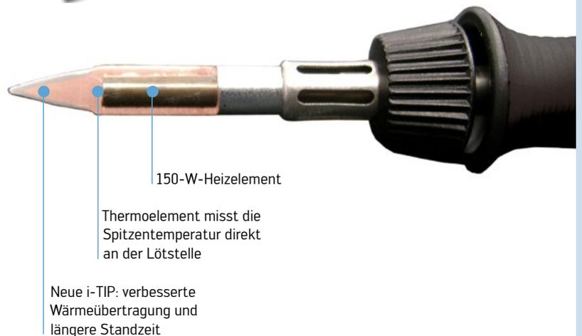
Der i-TOOL heizt so schnell, dass alle Lötverbindungen mit nahezu identischer Temperatur hergestellt werden können. Der Sensor misst die Ist-Temperatur ganz vorne an der Lötspitze. Der Prozessfensteralarm ermöglicht dem Bediener eine wiederholbare Lötqualität.
