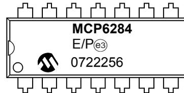
14-Lead SOIC (150 mil) (MCP6284)
