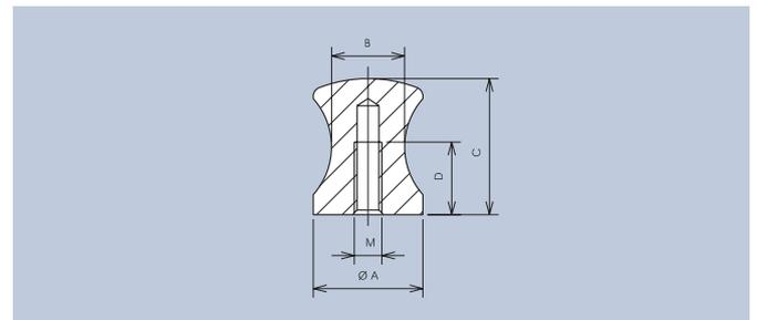
Einschließlich Zylinderschrauben-M3 x 8 bzw. M4 x 10 und Scheiben.
