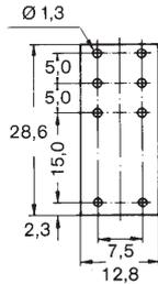
Monostabile Netztrennrelais, geeignet für alle üblichen Befluxungs-, Löt-, Reinigungs- und Waschmethoden. Isolationsaufbau nach VDE0110 Gr.C/250V AC/300VDC.=
