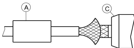
Abschirmung leicht aufspreizen und Kabel in Gehäuse C einführen.
