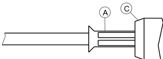
Hülse A über Abschirmung schieben und möglichst nahe am Gehäuse C klemmen.
