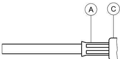
Hülse A über Abschirmung schieben und möglichst nahe am Gehäuse C klemmen.
