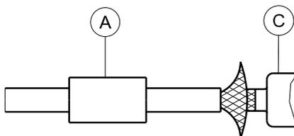
Abschirmung leicht aufspreizen und Kabel in Gehäuse C einführen.
