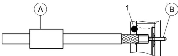
Kontakt B über Kabelinnenleiter bis zum Dielektrikum stossen und mit Aussparung 1 klemmen.
