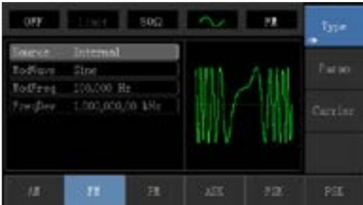
2) Stellen Sie das Modulationssignalparameter ein.
