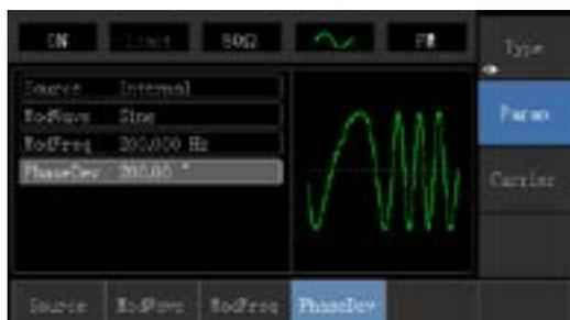
Die Form der PM-Modulationssignalforn, die durch das Oszilloskop geprüft wird, wird wie folgt dargestellt:
