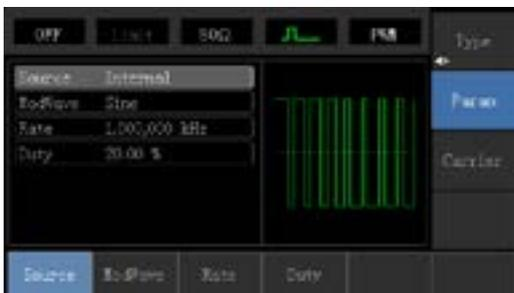
Geben Sie nach Drücken von **Parameter**→**Dutycycle** die Zahl 40 ein und drücken Sie den Softkey % über die Zahlentastatur, um die Abweichung den Tastgrad einzustellen.
