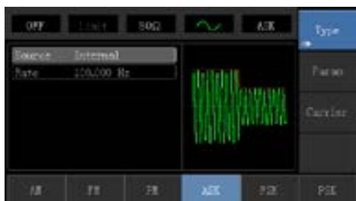
Drücken Sie den Softkey **Parameter** → **Rate** erneut, geben Sie dann die Zahl 300 ein und drücken Sie den Softkey **HZ** mit **Hz** (300 Hz) für die ASK-Rate einzustellen.
