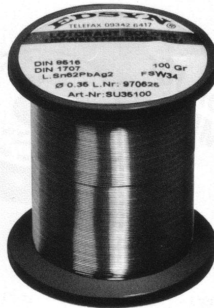
Gerade bei Fine-Pitch-Bauelementen mit feinsten Rastern ist der Einsatz von einem Löt draht mit einem Durchmesser von 0,35 mm, mit einem nahezu rückstandsfreien Flußmittel, unumgänglich. EDSYN SU 35100 hinterläßt nahezu keine Rückstände. Die spätere Bildung von Kriechströmen ist fast ausgeschlossen.
