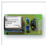
Option H085, oscil- lateur à haute stabilité
