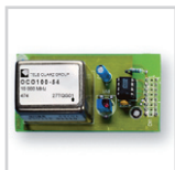
Option H085, oscil- lateur à haute stabilité
