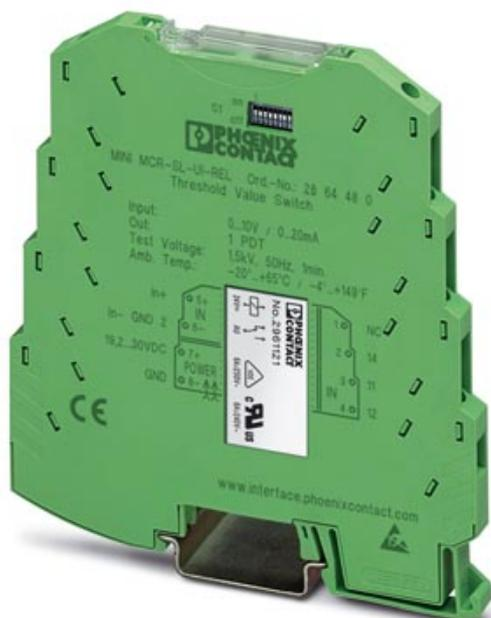
MINI MCR-Grenzwertschalter, mit einstellbarer Hysterese und Verzögerungszeit, Eingangssignale 0...20mA, 0...10 V, ausgangsseitig 1 Wechsler mit Schraubanschluss
