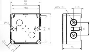
(W) 85 x (D) 85 x (H) 53 mm Polypropylene UL94-V0
