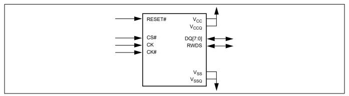
Figure 5 HYPERRAM<sup>™</sup> interface<sup>[4]</sup>
