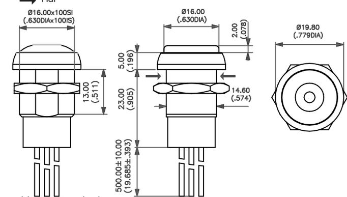
Wire colours : black : NO contact, red : LED anode(+), blue : LED cathode(-)
