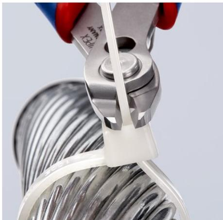
Para cortes a ras, como p. ej. para acortar abrazaderas de cable.
