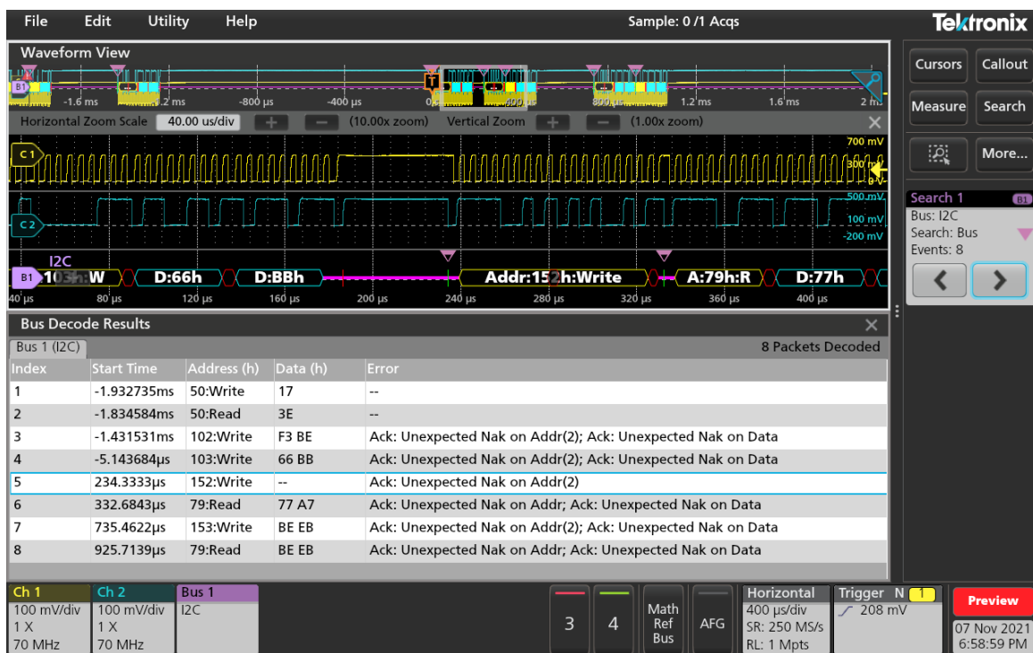
Una forma d'onda del bus fornisce pacchetti decodificati correlati temporalmente, mentre la tabella di decodifica del bus presenta tutti i pacchetti dell'intera acquisizione, la ricerca può essere utilizzata per navigare
