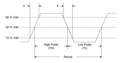
Figure 9. LVCMOS Waveform Diagram<sup>[13]</sup>
