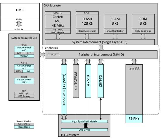
Figure 1. DMC Block Diagram<sup>[1]</sup>
