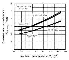
Fig. 8.9 R<sub>DS(ON)</sub> - T<sub>a</sub>
