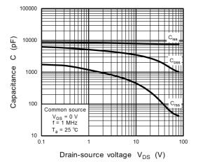
Fig. 8.11 Capacitance - V<sub>DS</sub>
