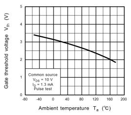
Fig. 8.8 V<sub>th</sub> - T<sub>a</sub>
