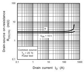
Fig. 8.5 R<sub>DS(ON)</sub> - I<sub>D</sub>
