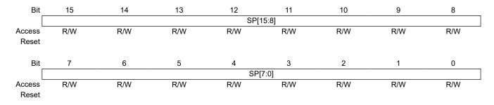
Bits 15:8 – SP[15:8] Stack Pointer High Byte
