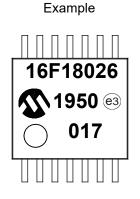
14-Lead SOIC (3.90 mm)
