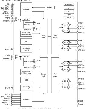
Figure 3. BD63888AEKV Block Diagram
