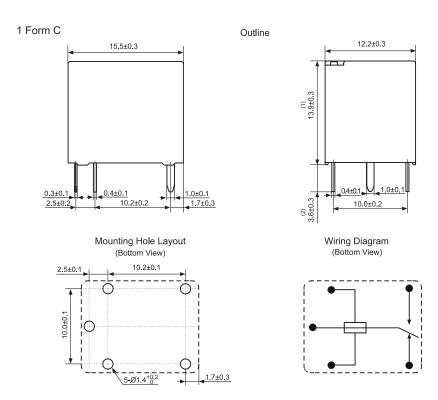
Note: Standard (1):13.9±0.3mm (2):3.6±0.3mm T-Reflow (1):14.5±0.3mm (2):3.0±0.3mm
