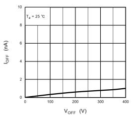
Fig. 12.1.10 I<sub>OFF</sub> - V<sub>OFF</sub>
