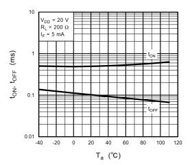
Fig. 12.1.8 t<sub>ON</sub>, t<sub>OFF</sub> - T<sub>a</sub>
