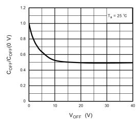
Fig. 12.1.11 C<sub>OFF</sub>/C<sub>OFF</sub>(0 V) - V<sub>OFF</sub>
