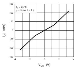
Fig. 12.1.4 I<sub>ON</sub> - V<sub>ON</sub>
