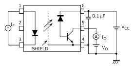
Fig. 13.1.4 IO Test Circuit
