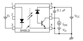
Fig. 13.1.1 I<sub>OH</sub> Test Circuit
