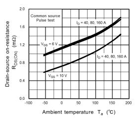
Fig. 8.9 R<sub>DS(ON)</sub> - T<sub>a</sub>
