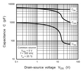
Fig. 8.13 Capacitance - V<sub>DS</sub>
