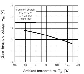
Fig. 8.12 V<sub>th</sub> - T<sub>a</sub>
