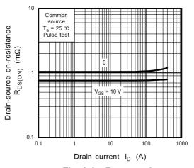
Fig. 8.8 R<sub>DS(ON)</sub> - I<sub>D</sub>
