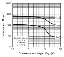
Fig. 8.13 Capacitance - V<sub>DS</sub>
