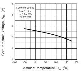
Fig. 8.12 V<sub>th</sub> - T<sub>a</sub>
