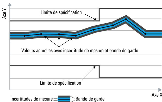
Les limites de test sont étroitement encadrées par des bandes de garde pour prendre en compte les incertitudes de mesure, le décalage et le vieillissement, si applicable.
