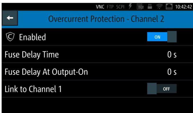
L'utilisateur peut régler des limites de sécurité pour restreindre la gamme d'ajustement de l'alimentation et empêcher qu'un DUT soit endommagé en utilisant un mauvais réglage.
