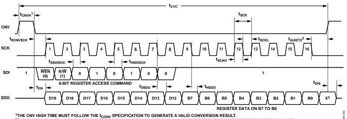
$^1$ THE CNV HIGH TIME MUST FOLLOW THE  $^1$ CONV SPECIFICATION TO GENERATE A VALID CONVERSION RESULT.  $^2$ THE SCK FALLING EDGE TO CNV RISING EDGE DELAY MUST FOLLOW THE  $^1$ CONVERSION TO ENSURE SPECIFIED PERFORMANCE.
