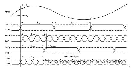
Figure 7. Wordwise DDR, One-Lane, 1× Frame, 12-Bit Output Mode
