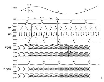
Figure 3. 12-Bit DDR/SDR, Two-Lane, 1× Frame Mode
