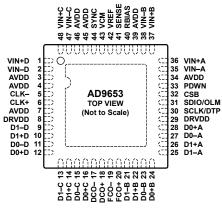
NOTES 1. THE EXPOSED THERMAL PAD ON THE BOTTOM OF THE PACKAGE PROVIDES THE ANALOG GROUND FOR THE PART. THIS EXPOSED PAD MUST BE CONNECTED TO GROUND FOR PROPER OPERATION.
