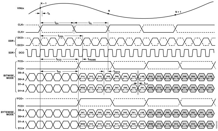
Figure 2. 16-Bit DDR/SDR, Two-Lane, 1× Frame Mode (Default)
