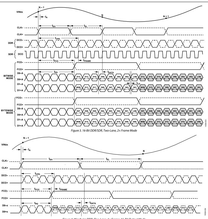
Figure 4. Wordwise DDR, One-Lane, 1× Frame, 16-Bit Output Mode
