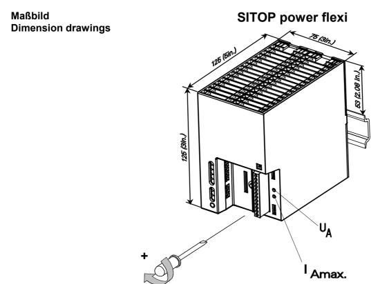
Einstellung  $U_A$  und  $I_{Amax}$  Adjustment  $U_A$  and  $I_{Amax}$
