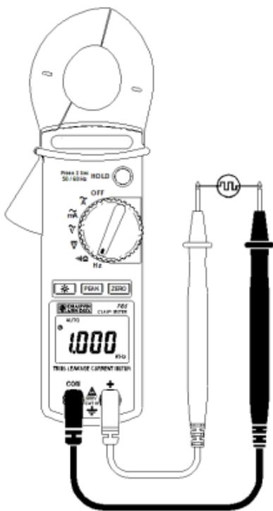
Connecter les cordons de test rouge à la borne d'entrée «+» et le cordon de test noir à la borne d'entrée «COM».
