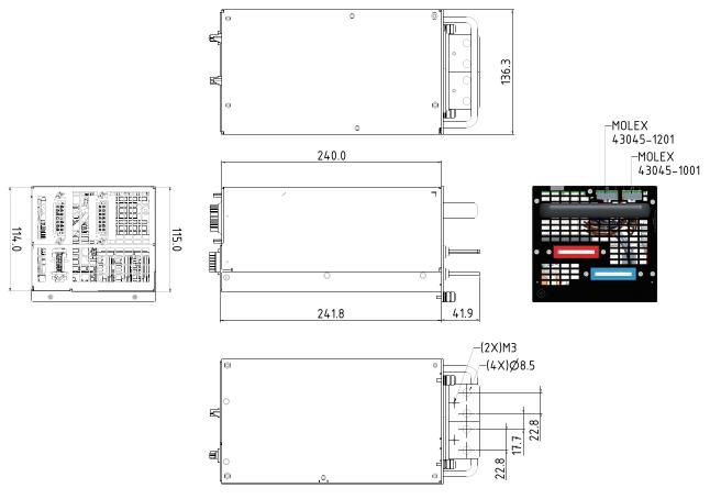
Note : Weight : 12kW 300V module (73-938-0300) - 5.1Kg 12kW 50V module (73-938-0050)
