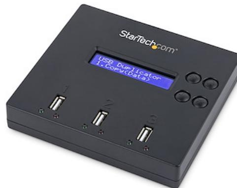
Mit diesem unabhängigen USB-Duplizierer können Sie zwei Flash-Laufwerke klonen oder löschen, ohne eine Verbindung zu einem Host-Computer herzustellen.
