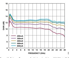
Figure 18. Gain vs. Frequency for Various  $I_{\rm DQ}$  Values, 200 MHz to 28 GHz,  $V_{\rm DD}$  = 15 V
