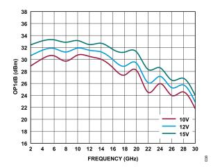
Figure 38. OP1dB vs. Frequency for Various  $V_{\rm DD}$  Values, 2 GHz to 28 GHz,  $I_{\rm DQ}$  = 500 mA
