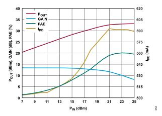
Figure 53.  $P_{\rm OUT}$ , GAIN, PAE, and  $I_{\rm DD}$  vs.  $P_{\rm IN}$ , 20 GHz,  $V_{\rm DD}$  = 15 V,  $I_{\rm DQ}$  = 500 mA
