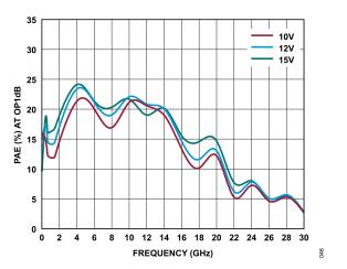
Figure 46. PAE at OP1dB vs. Frequency for Various  $V_{\rm DD}$  Values,  $I_{\rm DQ}$  = 500 mA
