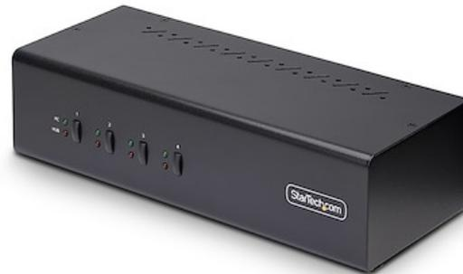
Ce commutateur KVM double moniteur permet aux utilisateurs de basculer entre quatre bureaux compatibles USB-A et DisplayPort. Il permet de partager deux moniteurs DisplayPort double 4K à 60 Hz, un clavier et une souris, ainsi que deux périphériques USB 5 Gbit/s.
