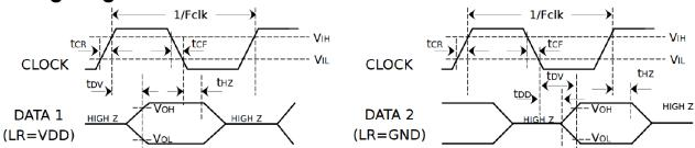
$t_{\text{DD}} \colon 19 \text{ns} \quad t_{\text{Hz}} \colon 5{\sim}16 \text{ns} \quad t_{\text{DV}} \colon 73 \text{ns} \quad t_{\text{CR}} \, / t_{\text{CF}} \colon \text{max} 13 \text{ns}$
