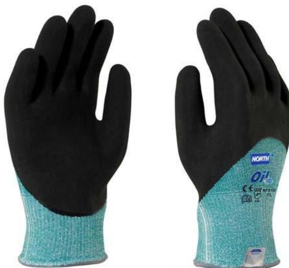
**Description :** Gant tricoté sans couture en Dyneema et fibres de verre avec le plus haut niveau de protection 5 selon EN388. Pour la résistance à l'huile le gant est traité avec une enduction double de nitrile spéciale. La combinaison parfaite de haute sensibilité et très haute protection coupe.
