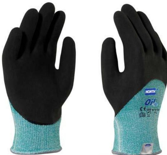
**Beschreibung:** Nahtloser Dyneema / Glasfaser geschnitten Handschuh mit der höchsten Schutzstufe 5 nach EN388. Dieser Handschuh ist Öl resistent gemacht mit einem speziellen 2-faches getauchten Nitrilbeschichtung. Die perfekte Kombination von hoher Empfindlichkeit und sehr hoher Schutz vor Schnittverletzungen.
