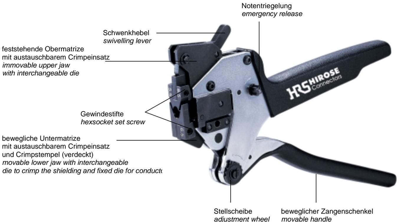
Die Zange besteht aus einer Grundzange mit Stellscheibe und Notentriegelung und einer speziellen Crimpeinrichtung. Diese besteht aus einem Crimpstempel für 8-poligen Leitercrimp, einer beweglichen Untermatrize, einer feststehenden Obermatrize mit Schwenkhebel und austauschbaren Crimpeinsätzen für die Kabelabschirmung je nach Kabeldurchmesser
