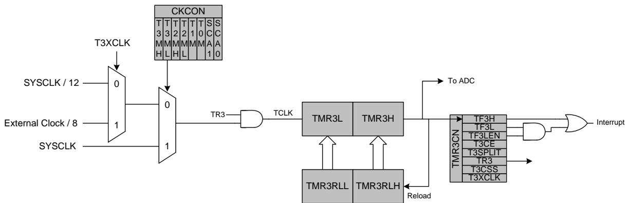
Figure 21.8. Timer 3 16-Bit Mode Block Diagram
