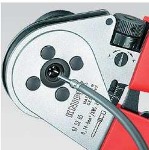
Vierdornpressung für zuverlässige Crimpverbindung
